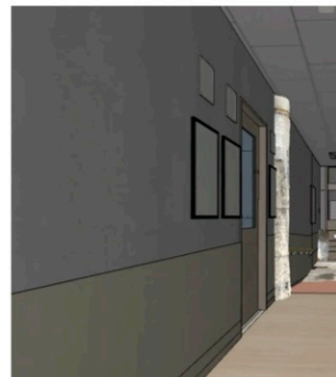
図1 設計モデルでは壁内に柱が納まっていたが、点群データを重ねると柱が出てくるのが判明
