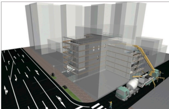
意匠+施工モデルで仮設計画を 3D 上で確認
